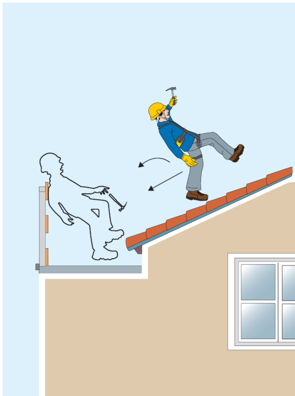
Figura 3 - Inclinazione della superficie di lavoro (inciampo)
