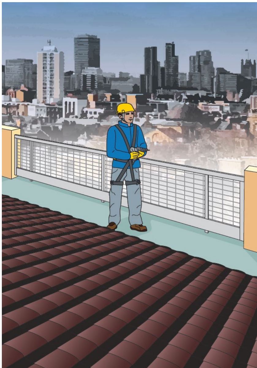
Figura 6 - Manutenzione di un parapetto anticaduta permanente di classe B
