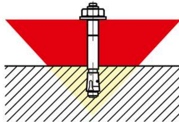
Profondità di posa insufficiente
